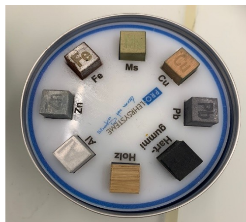
Activité 2 : TP masse volumique (technique de l'immersion)
