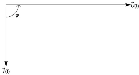
Rappelons que le déphasage  $\varphi$  représente *le retard de phase du courant sur la tension* ou, en d'autres termes, *l'avance de phase de la tension sur le courant*.
