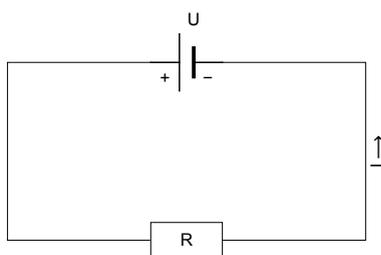
La résistance électrique R est exprimée en ohms [Ω].
