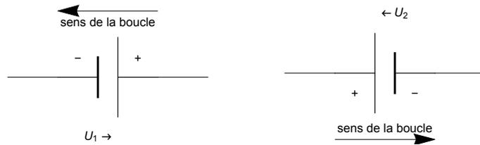
**+ R·I** lorsque le sens du courant et le sens de la boucle coïncident :
