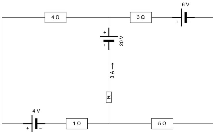
Calculez la résistance  $R$  afin qu'elle soit traversée par un courant de  $3\text{ A}$  dans le sens indiqué dans la figure.
