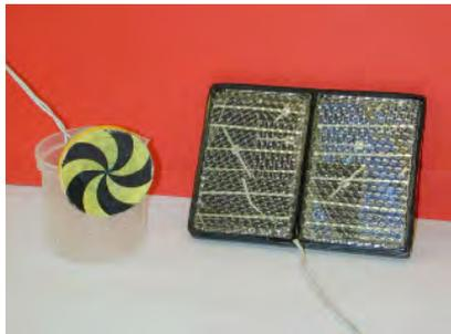
13) Ici, on peut transformer l'énergie qui nous vient du Soleil (ou d'une ampoule) en mouvement de l'air grâce au capteur à cellules photovoltaïques, au moteur électrique et à l'hélice du ventilateur. Cache une plus ou moins grande partie du capteur solaire, approche et éloigne la lampe, oriente le capteur de manière à ce que la lumière arrive plus ou moins obliquement dessus ! Quand est-ce que le ventilateur tourne le plus vite ?
