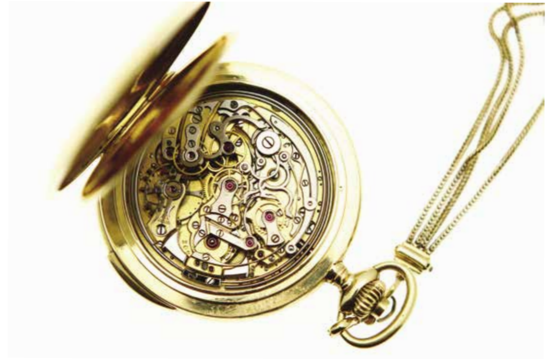
Ill. 4 Mécanisme d'une montre à répétition minute et chronographe d'Ami Rochat, 1932.
