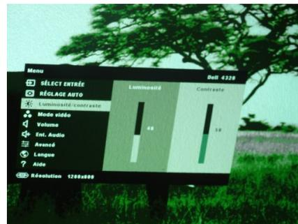
b) Pour régler le canal de sortie, appuyez sur **menu** 1x, puis 1x sur la **flèche** de droite et le menu "sélect entrée" est mis en évidence sur notre écran. Vous pouvez alors régler le canal en appuyant sur les **flèches** haut et bas. Quand cela vous convient, appuyer 1x sur **enter**. Si vous n'avez pas d'autres réglages à faire vous pouvez appuyer sur **menu** 1x.
