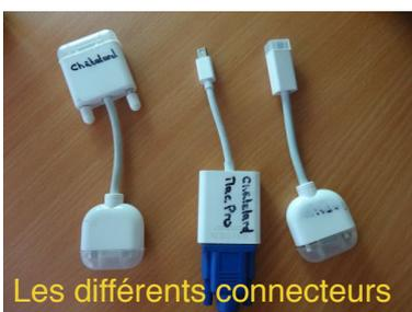
Pour brancher le beamer sur votre ordinateur, vous aurez besoin du câble de l'appareil et d'un connecteur entre le câble et l'ordinateur. Ce dernier change d'un ordinateur à l'autre suivant le modèle d'ordinateur que vous avez.
