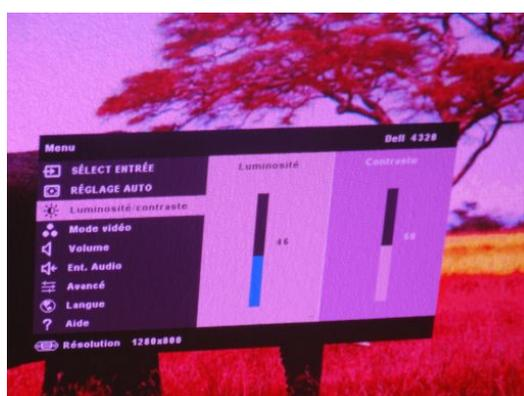
a) Pour régler les contrastes : appuyez sur **menu** 1x, puis 2x sur la **flèche** vers le bas et l'onglet "luminosité-contraste" est sélectionné sur votre écran. Appuyez 2x sur la **flèche** de droite et vous pouvez alors régler la luminosité avec les flèches haut-bas. Quand cela vous convient, appuyer 1x sur **enter**. Si vous n'avez pas d'autres réglages à faire vous pouvez appuyer sur **menu** 1x.
