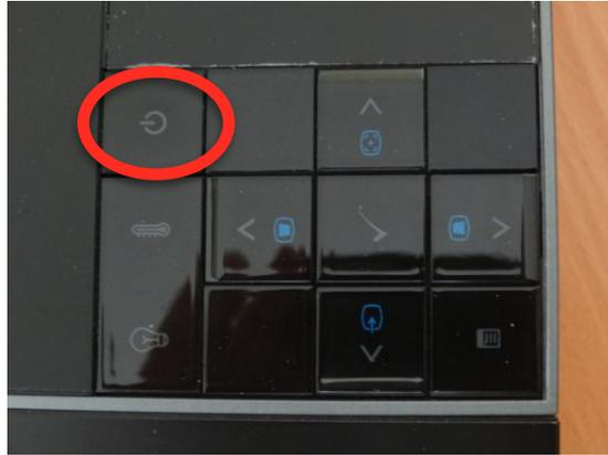
**!! ⚠ !!** Lorsque vous avez fini votre projection, vous devez impérativement éteindre le beamer en appuyant deux fois sur le bouton power et attendre que l'ampoule refroidisse **sans enlever la prise du courant**. L'ampoule a refroidi, lorsque le beamer ne fait plus de bruit. **!! ⚠ !!**
