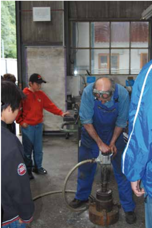
Rivetage à chaud à l'atelier.
