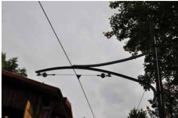
Les potences soutiennent les fils électriques.
