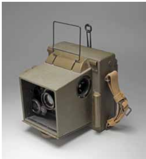
Fig. 11 Appareil de reportage à usage militaire Combat Graphic, Folmer Graflex Corporation, Rochester, USA, dès 1942. Commandé par le gouvernement des Etats-Unis à la Folmer Graflex Corporation qui n'a disposé que de quelques mois pour le concevoir et le fabriquer; cet appareil est une adaptation de l'Anniversary Speed Graphic produite en 1940 et s'est vendu dès 1945 en version civile sous l'appellation Graphic 45.
