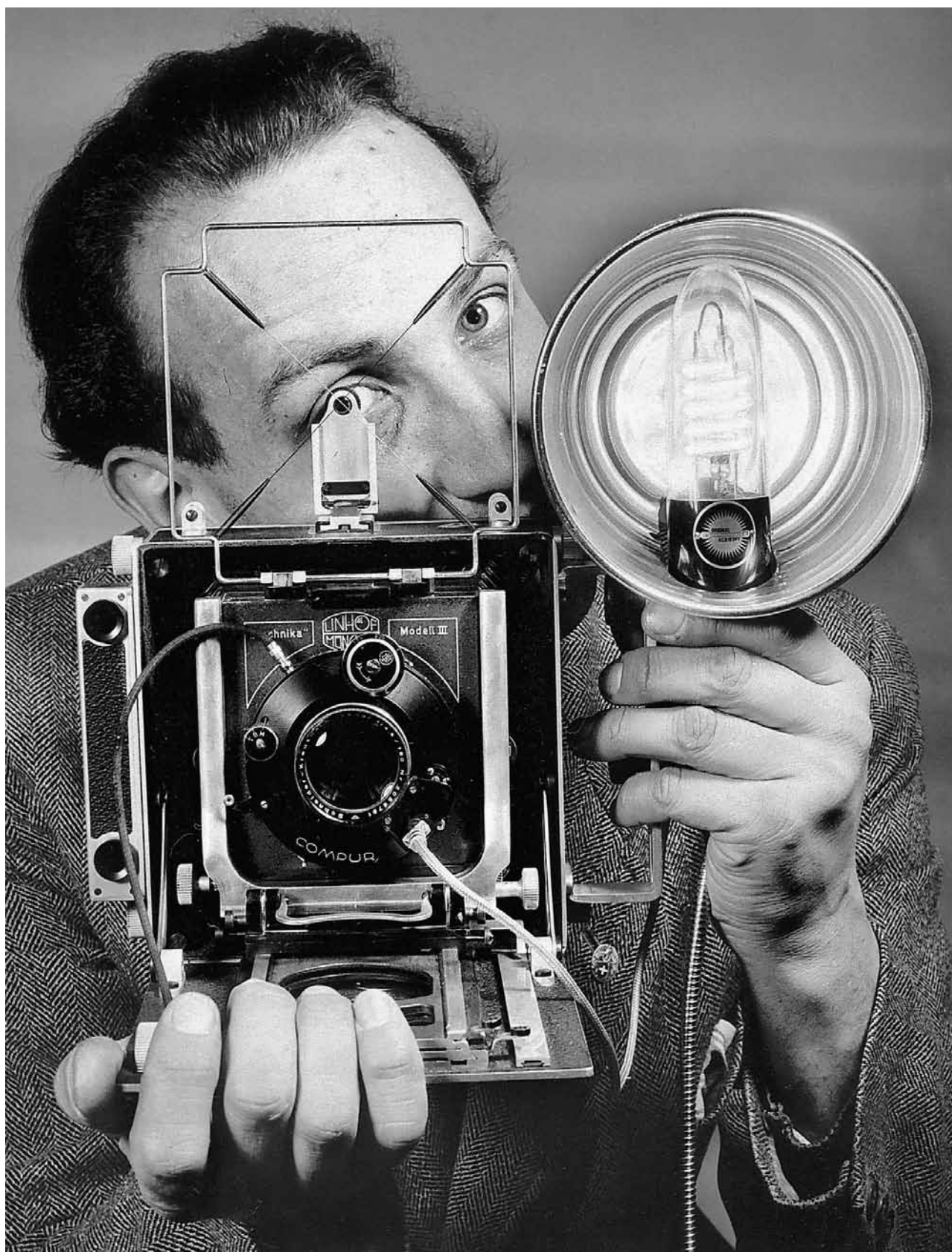
Fig. 15 Autoportrait de Dimitri Rebikoff avec sa chambre Linhof Technika équipée d'un flash électronique portable. Cet ingénieur russe d'origine a travaillé à la mise au point d'un flash électronique dès 1943 à Paris, puis en Suisse.
