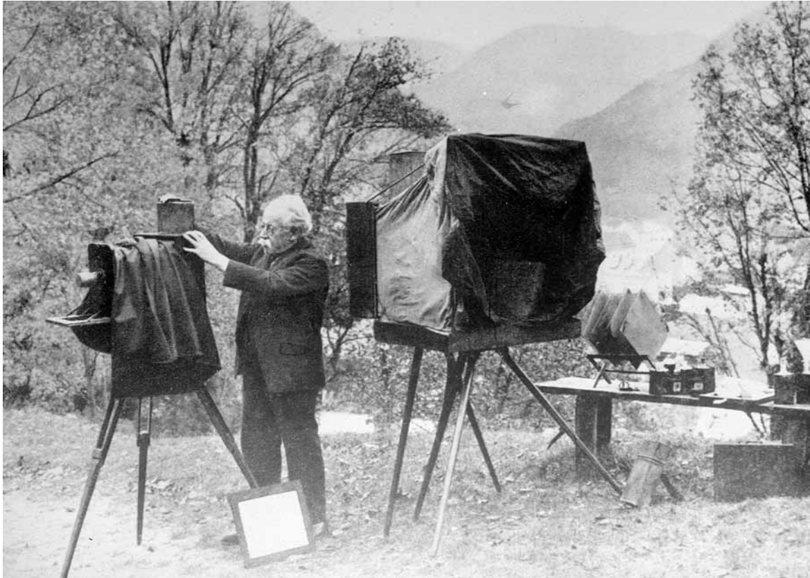
Fig. 2 Chambre de voyage et tente-laboratoire installée pour la prise de vue en extérieur, auteur inconnu, fin du XIX e siècle.
